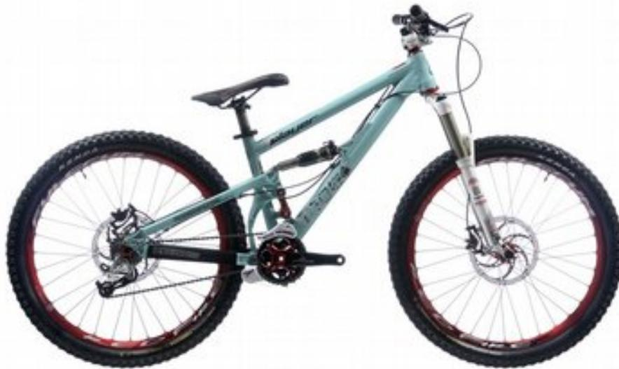
Le mtb da dirt/street , anch'esse poco inclini alla pedalata, sono delle front suspended con specifiche adatte alle acrobazie, che si realizzano principalmente su ostacoli artificiali. Sono delle front suspended con forcella ad escursione limitata ma con telaio molto rigido e robusto, così come le ruote, che in alcuni casi possono essere anche con diametro 24" anziché 26.
